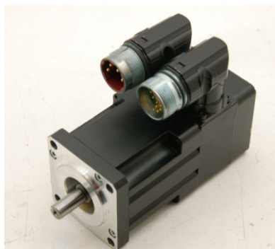
Slika 2.5: Brezkrtačni industrijski AC servomotor ( Allen-Bradley tip MPL) s konektorji za napajanje in dajalnik položaja (enkoder), nazivni navor 1.25 Nm, max. hitrost 4000 obr/min
