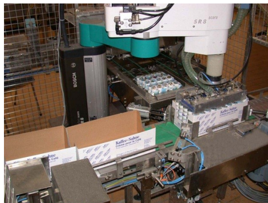
Slika 2.8: Tipična Pick-and-place operacija s SCARA robotom Bosch , aplikacija je zlaganje izdelkov v škatle
