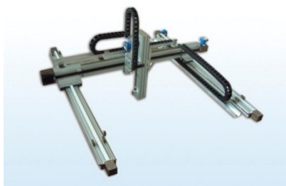
Slika 1.9: Kartezični ( Gantry ) robot, sestavljen iz linearnih vodil s servopogoni
