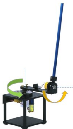
Slika 7.1: Furuta tip nihala na pilotni napravi, puščici prikazujeta dve osi vrtenja
