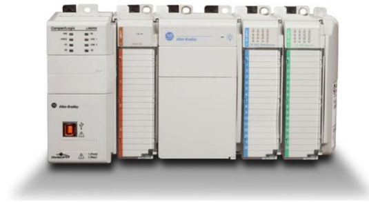
Slika 1.2: Modularni PLC družine Logix, CompactLogix (od leve proti desni: CPU enota, modul 8xAI, napajalnik, modul 16xDI, modul 16xDO)
