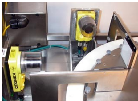
Slika 7.5: Dve kameri za strojni vid proizvajalca Cognex , montirane pod pravim kotom
